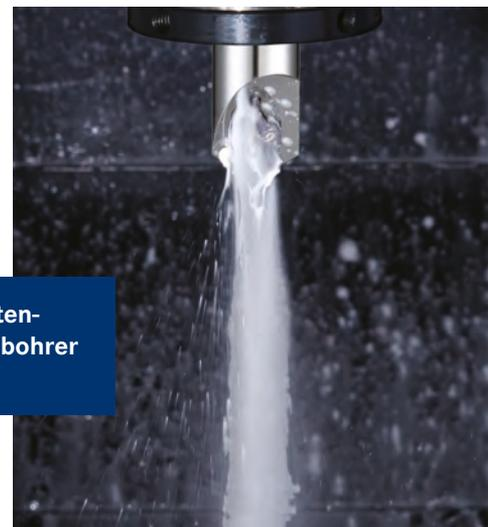
Kühlung kann direkt durch den Bohrer auf die Wendeplattenspitze geführt werden.
